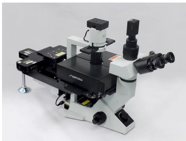
研究グループが開発した自動光学式細胞除去装置
