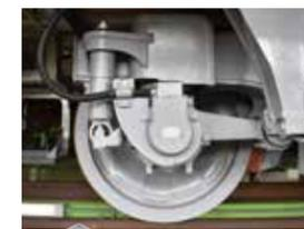
铁路车辆用速度检测器
