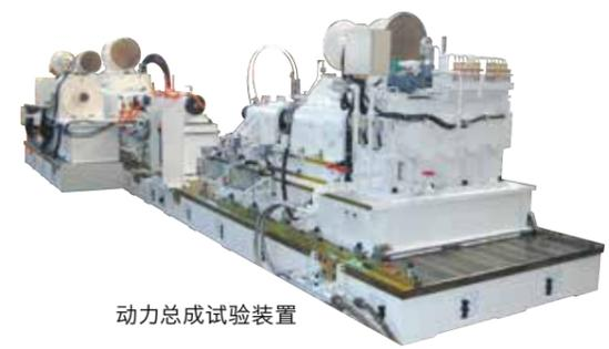
动力总成试验装置
