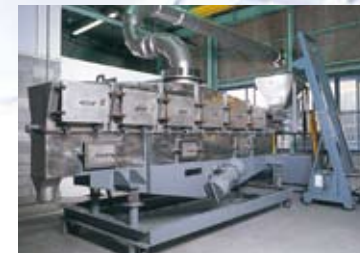
对振动干燥及冷却过程进行安装测试
