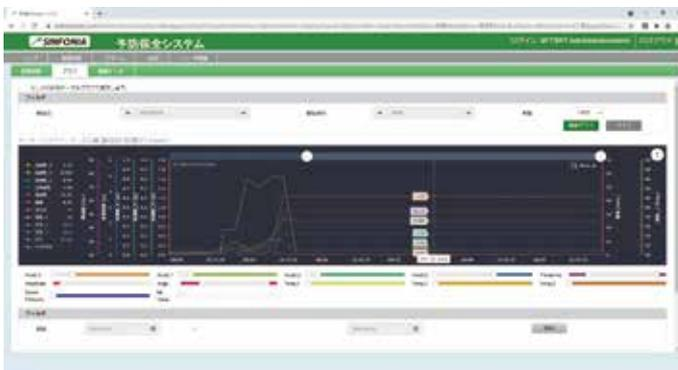
各設備について、拠点 - 部門 - 設備ごとの3階層で管理することができ、維持管理の高度化を支援します。計測値をグラフにより表示し、各計測項目の変化を知ることができます。また、計測値が設定したアラーム値を超えた時に、警報のメールを登録先アドレスに送る、警報メールに対応しています。
