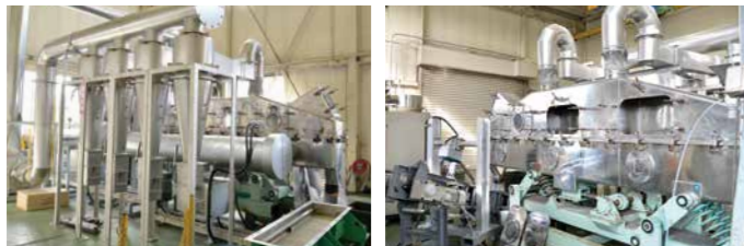
振動乾燥・冷却実験設備
